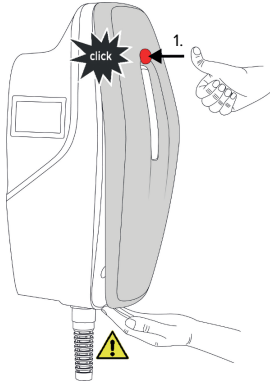
Fig. 19: Colocación de la cubierta frontal - 1
